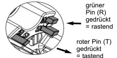
**Anschluss an 1 Rohrmotor**
