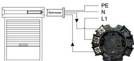
**Anschluss an 1 Rolllor- / Rohrmotor-Steuerung**
